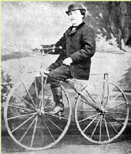
En 1861, les frères Pierre et Ernest Michaux, de Paris, ont créé un système de pédalage "rotatif", à l'origine du concept actuel. Ils ont fixé deux manivelles et des pédales au moyeu de la roue avant. En pédalant, la rotation de la roue avant met le vélo en mouvement.
